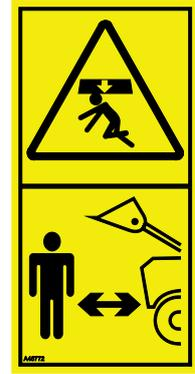
Tenere presente che il braccio del caricatore può essere abbassato o inclinato anche se il motore è stato spento (pericolo di schiacciamento). La pala caricatrice non è concepita per tenere un carico sollevato per lunghi periodi. Abbassare sempre l'accessorio in una posizione sicura prima di abbandonare il sedile del conducente.
